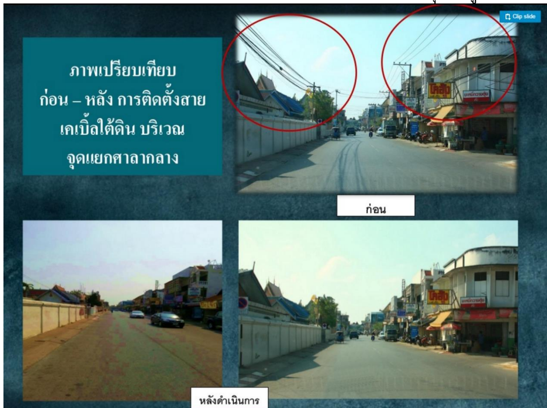
ภาพเปรียบเทียบ ก่อน - หลัง การวางระบบสายเคเบิลใต้ดินบริเวณ จุดแยกศาลากลาง
